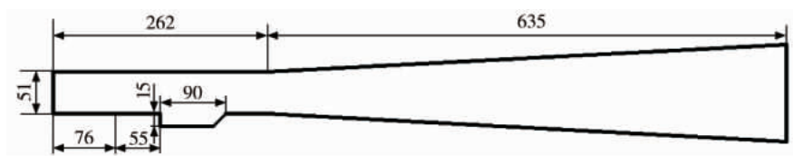
图 2 超燃燃烧室示意图(单位:mm)
